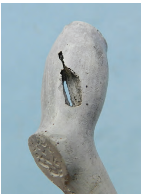
Afb. 10. Gat door meegebakken plantaardige verontreiniging. Geglaasd, hielmerk WS met twee lelies, H. 32 / O. 10 mm, 1595-1620.
